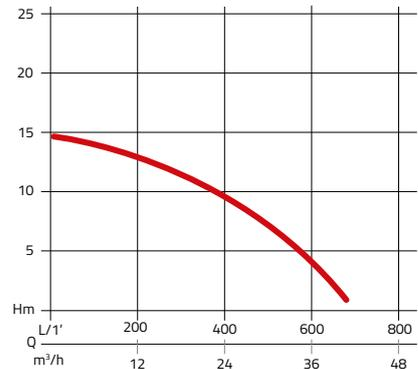
Die Diagramme zeigen Ihnen die Pumpleistung der Rössle Tauchpumpen FLAT-ROSS, C-ROSS und B-ROSS in m³ pro Stunde in Relation zur Pumphöhe.
