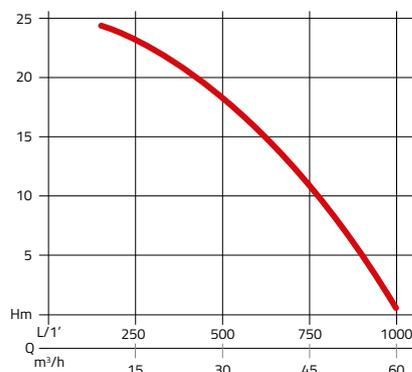
Die Diagramme zeigen Ihnen die Pumpleistung der Rössle Tauchpumpen KILO, MEGA und TERA in m³ pro Stunde in Relation zur Pumphöhe.
