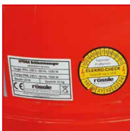
Elektrische Prüfung nach DIN
