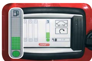
Ablesen des Tankfüllstandes im Stillstand möglich
